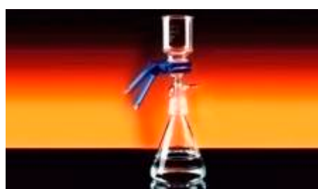
Sistema de Filtração em Vidro Borosilicato ou Inox
